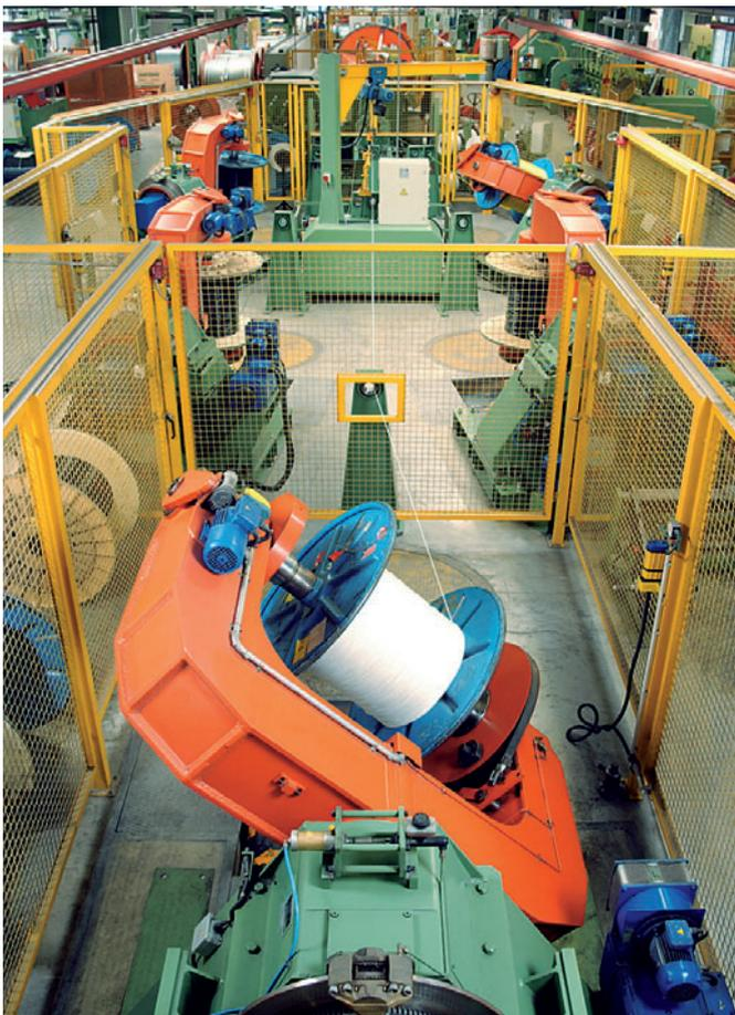
Großverseilmaschine mit Rückdrehung in unserem Werk in Windsbach.
