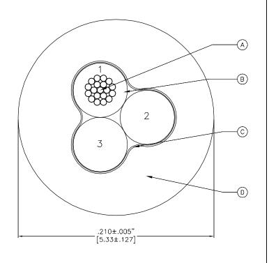
ELECTRICAL REQUIREMENTS DIELECTRIC WITHSTAND VOLTAGE: 1.5 KVAC
