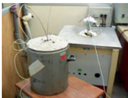
Kalibrierung durch Vergleichsmessung im Salzbad
