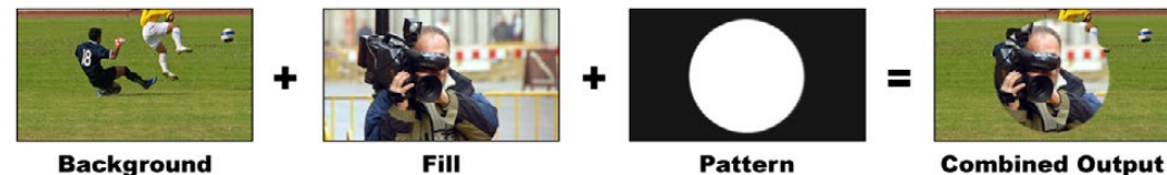
Combiner un arrière-plan avec un signal fill et un signal key comportant un motif (pattern)
