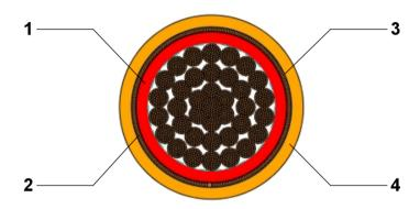
1. 1 Core 70 mm<sup>2</sup> Structure ISO-C
